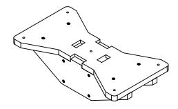
POST MOUNT BASE ASSEMBLY ATR-A0009(ATR2065) ATR-A0010(ATR2050) ATR-A0011(ATR2055) ATR-A0012(ATR2060)
